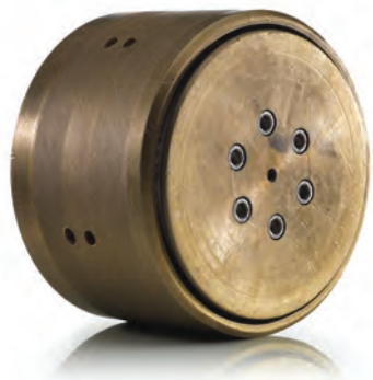
Una delle 15 trafile in bronzo usate nel laboratorio Canuti
